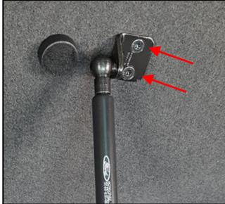
3. Die Liege wieder ablassen und die Scharnierbefestigung demontieren. (je 2 Schrauben TX40)
