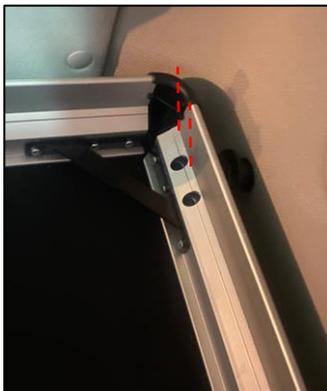
3. Mit Hilfe eines zusammengerollten Stück Papiers können die beiden Zylinderschrauben M8x20 (TX40) einfach in die beiden Löcher eingefädelt und verschraubt werden.
