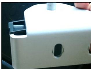
3. Die ursprünglichen Schrauben werden **anfangs nur handfest** angeschraubt. Dabei werden die Liegen-Aufnahmen so weit wie möglich nach außen in das Lager gedrückt und der Abstand zu den Fahrzeugwänden auf beiden Seiten vermittelt.
