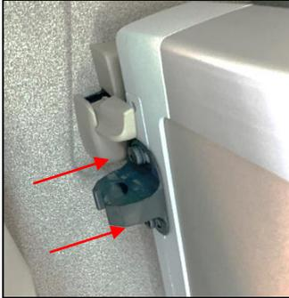
3. Demontage der **Gelenk-Aufnahme** links und rechts. (4 Schrauben TX45)
