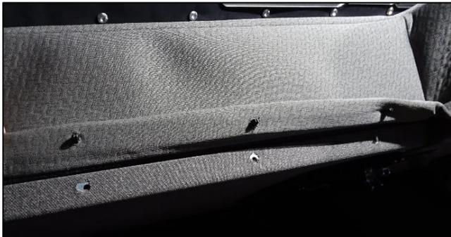
3. Lösen der unteren Front-Verschraubung (TX20).
